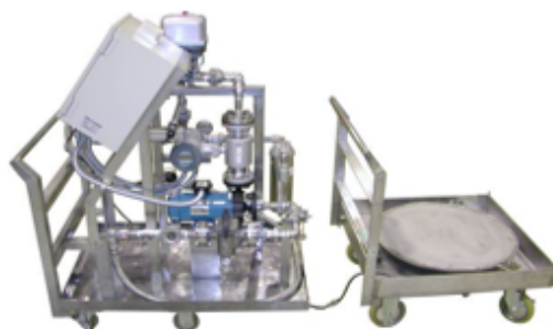
高濃度 P C B 絶縁油抜油装置
